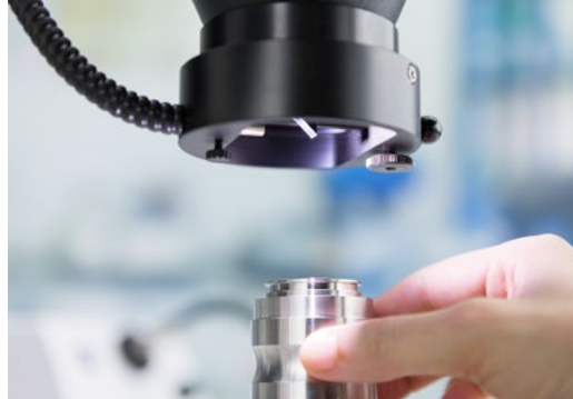
Delikleri, çıkıntıları ve derinleşmeleri S dikey aydınlatıcı ile inceleyin. Aydınlatıcının 45 derecelik aynası ayarlanarak vinyet oluşumu önlenebilir.
