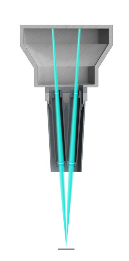
Greenough tipi bir stereo mikroskobun şematik ışın yolu.
