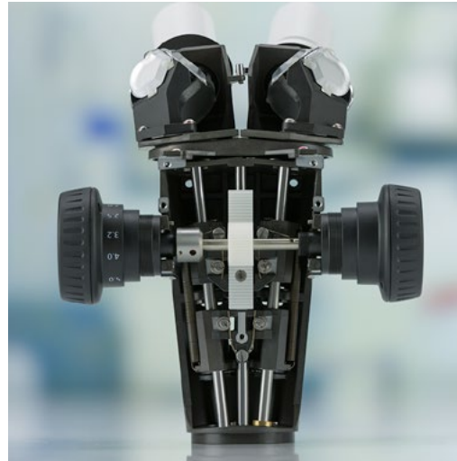
ZEISS Stemi 508, yakınlaştırma özelliği 8:1 oranında olan Greenough tipi güçlü bir optik sisteme sahiptir. Etkili bir stereoskopik görüntü gösterimi için ikiz gövde tüpleri 11° eğimlidir.
