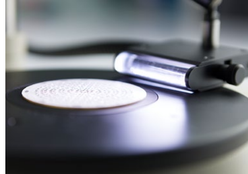
Çizgisel ışık S, homojen bir yandan aydınlatma örtüsü sağlar. Bu özelliği, büyük düz numunelerin yüzey yapılarında güçlü gölgelerle kontrast elde etmek için kullanın.
